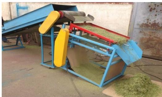
Рисунок 4 – Общий вид сепаратора листовой части трав (фрагмент проведения опытов)
