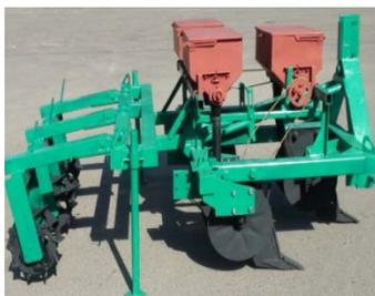
Рисунок 2 – Лабораторная установка для проверки работоспособности комбинированного орудия для полосовой обработки почв
