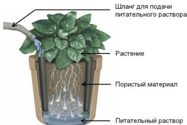
Рисунок 1 – Простейшая фитильная гидропонная система
