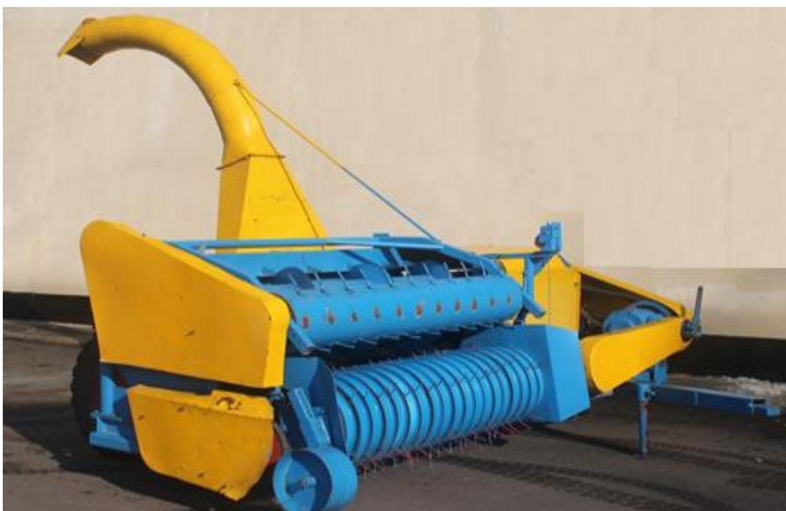
Рисунок 1 – Общий вид универсального подборщика-измельчителя кормов
