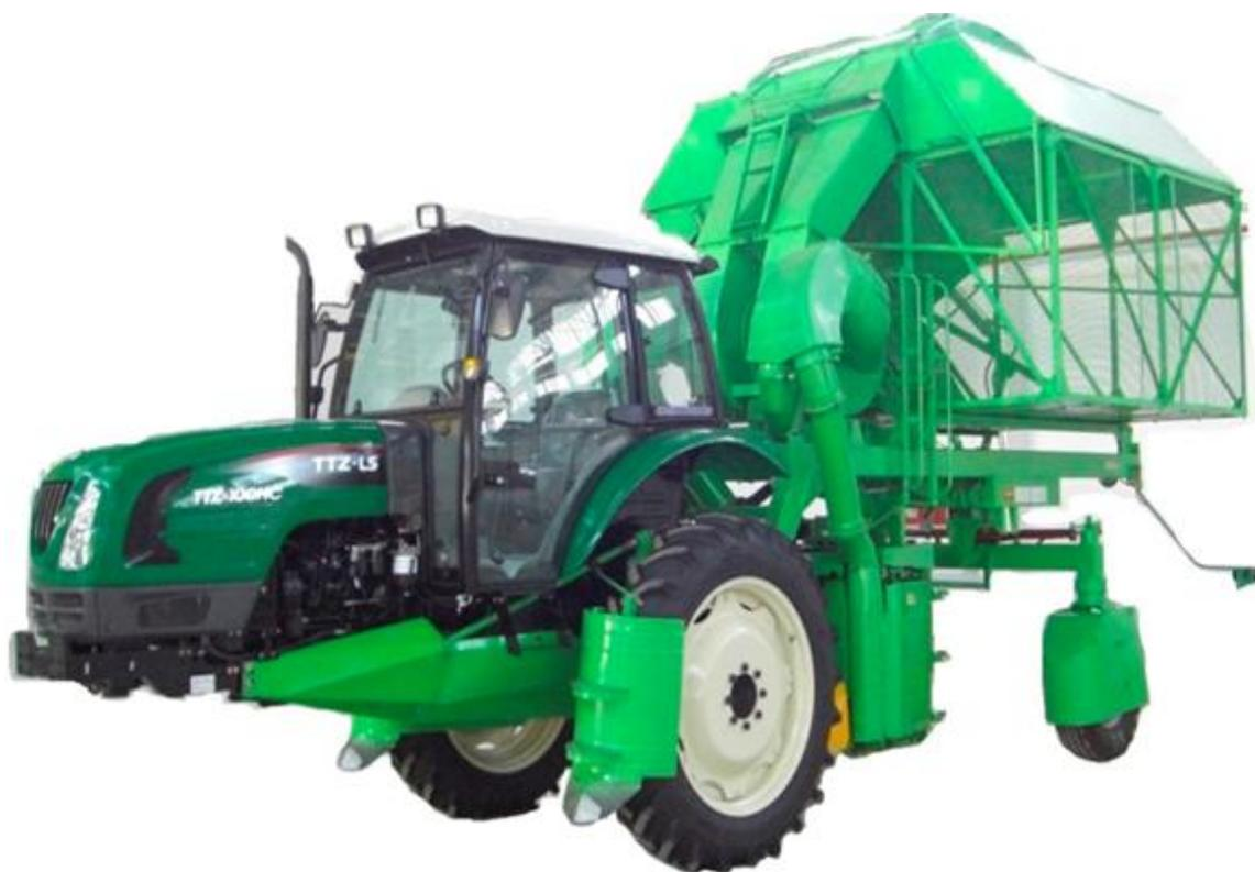
Рисунок 1 – Модернизированная прицепная хлопкоуборочная машина МХ-1,8
