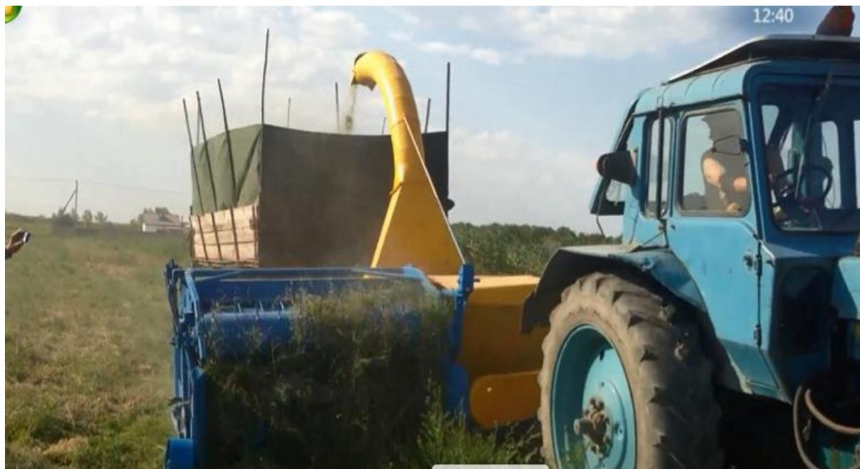
Рисунок 3 – Процесс работы подборщика-измельчителя с подпрессовывающим барабаном с шестью рядами пальцев
