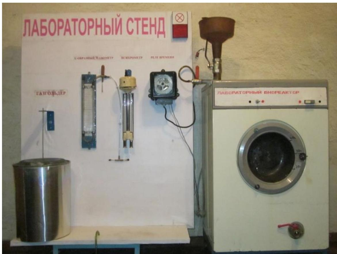
Рисунок 2 – Общий вид лабораторного стенда для исследования режимов работы биогазовой установки
