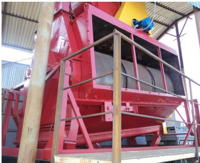
Рисунок 1 – Экспериментальный образец машины для предварительной очистки зернового вороха
