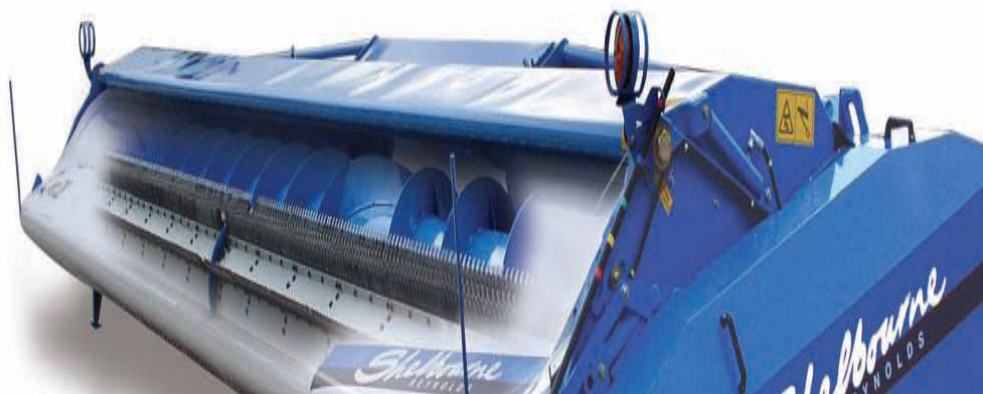
Рисунок 5 – Жатка Shelbourne для очеса колосьев зерновых культур
