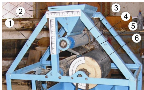
1 – рама; 2 – бункер; 3 – дозирующий барабан; 4 – скатная доска; 5 – натирающая щетка; 6 – диэлектрический барабан
