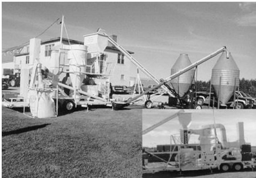
Рисунок 2 – Стационарная система МакЛеода для очистки зерна от половы
