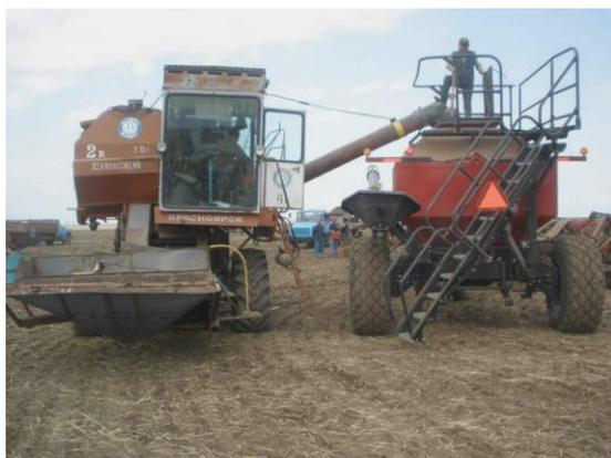
Рисунок 3 – Загрузка ПК самоходным загрузчиком на базе зерноуборочного комбайна «Енисей»
