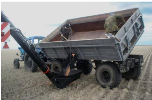
Рисунок 1 – Загрузка ПК штатным загрузчиком, подвозка семян тракторным прицепом с боковым разгрузочным окном
