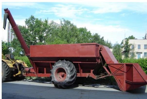
б) полуприцепной на базе «Дон-20»
