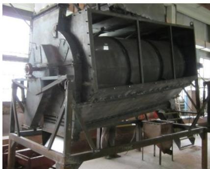
Рисунок 3 – Макетный образец двухбарабанного очистителя зернового вороха
