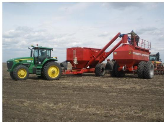
Рисунок 4 – Загрузка ПК полуприцепным загрузчиком «ХоршАгроСоюз»
