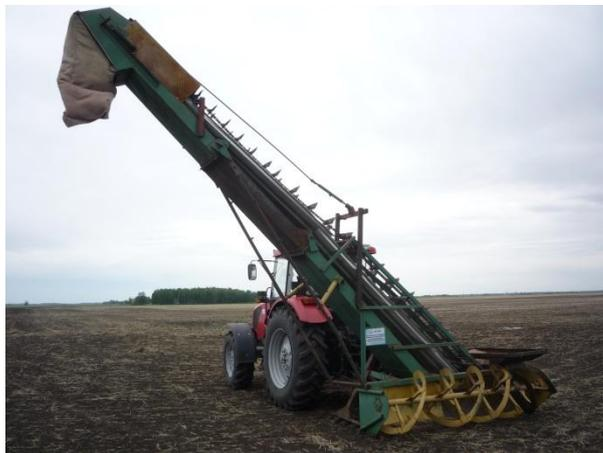
Рисунок 5 – Навесной загрузчик ПК на базе ПЗН-70
