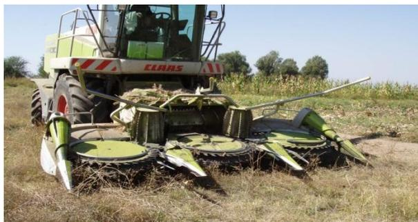
Рисунок 2 – Роторная шестирядная жатка фирмы Кемпер комбайна Ягуар 830
