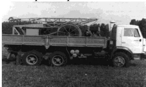
Предназначен для ремонта скважин по восстановлению их дебита, а также шахтных колодцев. Рекомендуется для сельскохозяйственного водоснабжения и других водохозяйственных объектов, имеющих скважины и шахтные колодцы.
