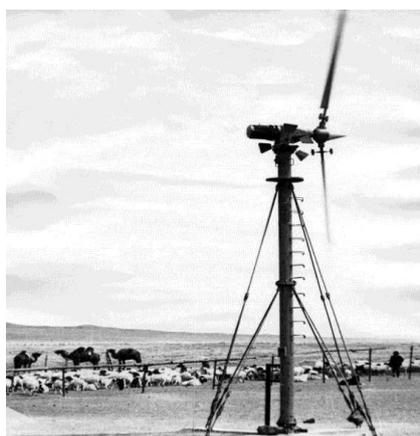
Рисунок 3 – Ветроэлектрический агрегат АВЭУ 6-4 на водопойном пункте
