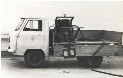
*Передвижная водоподъемная установка ППВ-УАЗ*
