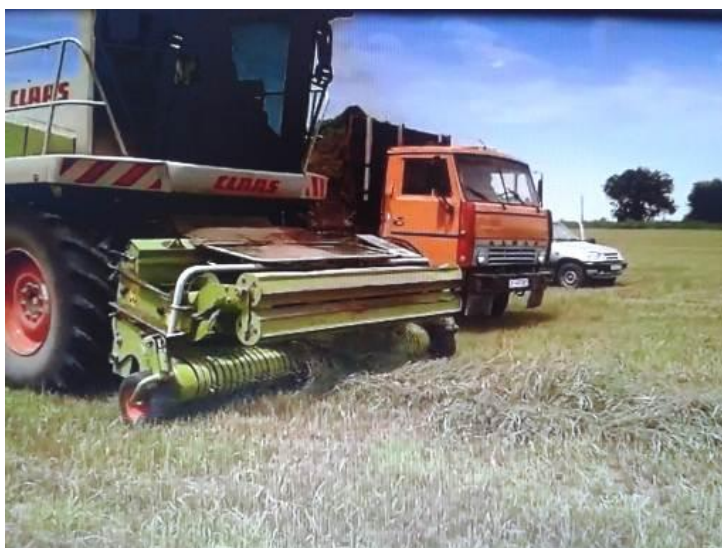
Рисунок 3 – Кормоуборочный комбайн Ягуар 830 Подбор и измельчение валков люцерны на сенаж
