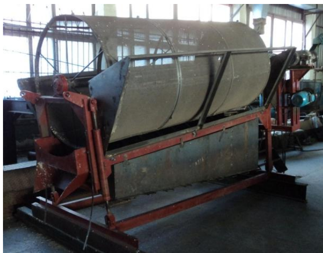
Рисунок 2– Лабораторная установка для обоснования параметров и режимов работы цилиндрического решета для отделения мелкой примеси
