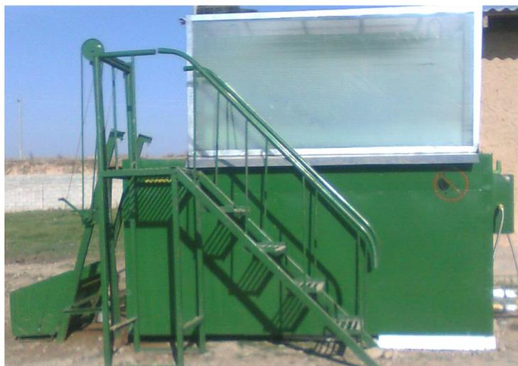
Рисунок 2 – Биогазовая установка БУ-5 установленная в малом фермерском хозяйстве на ферме с поголовьем 40 коров
