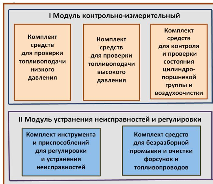
Рисунок 2 – Конструктивно-технологическая схема устройства для комплексного контроля и оперативной настройки системы топливоподачи дизелей
