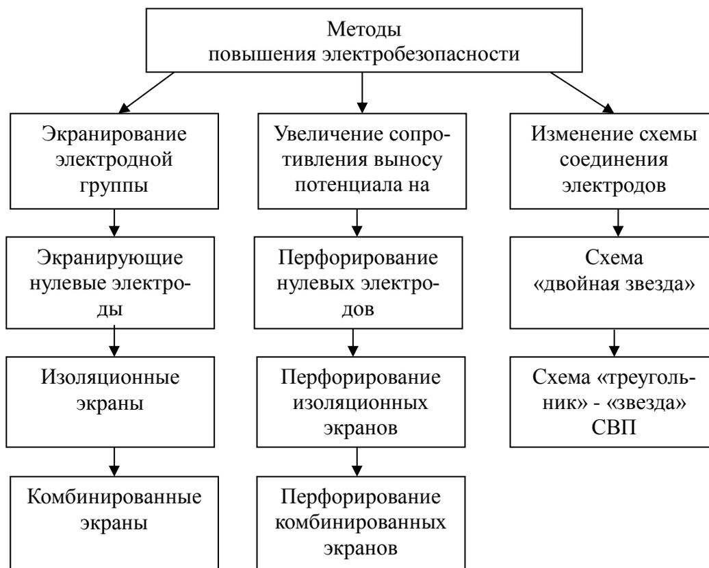
Рисунок 5 – Классификация разработанных методов повышения электробезопасности ЭВН
