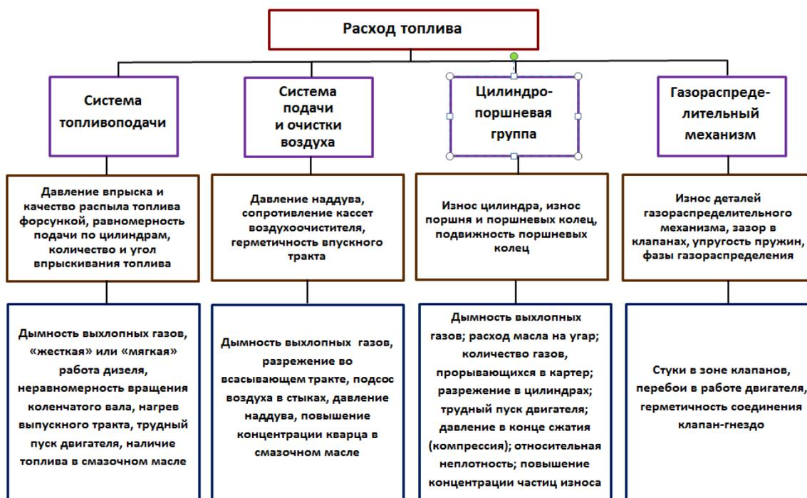
Рисунок 1 – Параметры состояния систем и механизмов дизеля, влияющие на расход топлива
