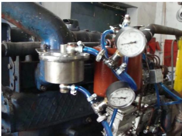
Рисунок – Макетный образец сигнализатора засоренности топливных фильтров на лабораторных испытаниях
