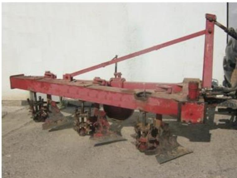
Рисунок 1 – Общий вид плуга с роторными отвалами
