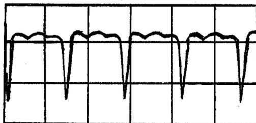
Рисунок 3 – Осциллограмма напряжения на входе электрофильтра
