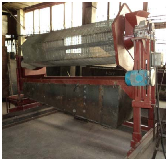
Рисунок 1 – Общий вид макетного образца машины для предварительной очистки зернового вороха
