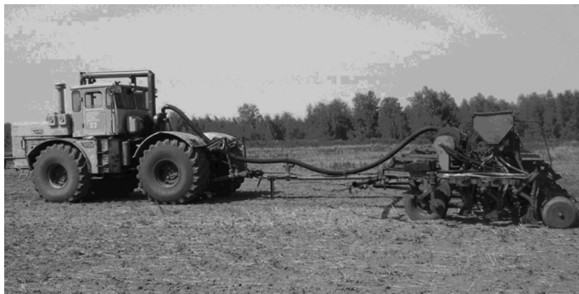
Рисунок 4 – Устройство для внесения выхлопных газов в почву, установлена на тракторе К-701
