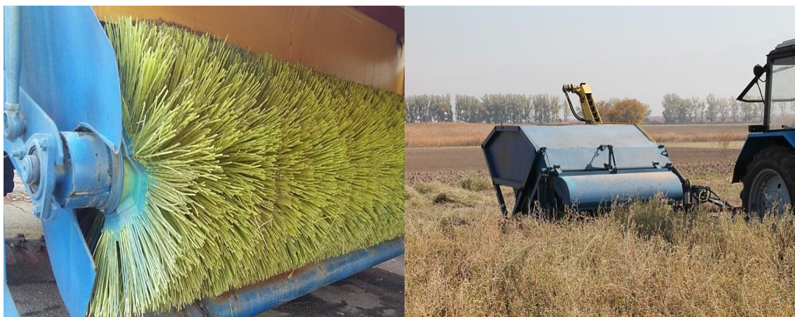
Рисунок 8 – Очесывание семян люцерны прицепной универсальной машиной
