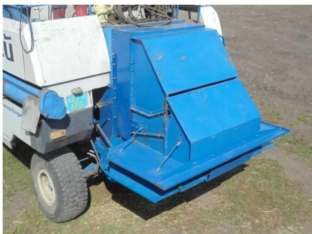
Рисунок 1 - Измельчитель-разбрасыватель соломы на комбайне Енисей КЗС-950
