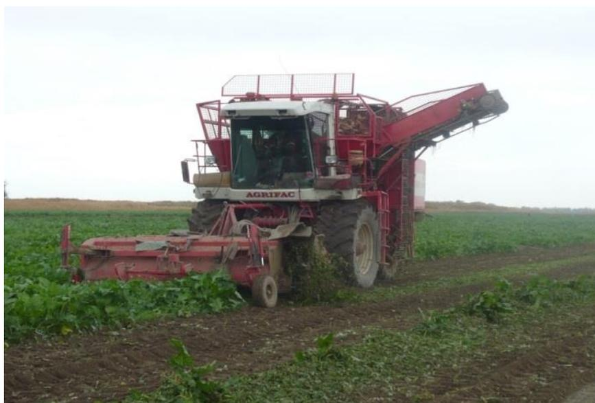
Рисунок 1 – Свеклоуборочный самоходный комбайн WKM-9000 в работе
