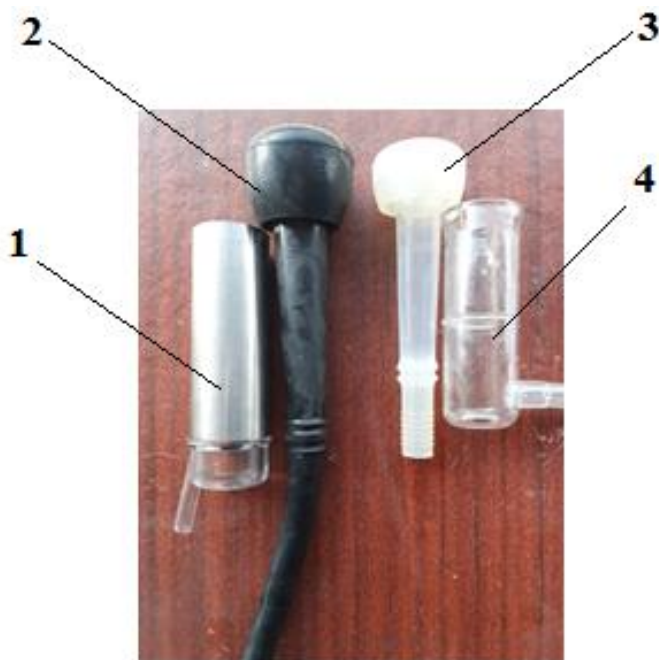
1 и 2- стакан и сосковая резина существующей конструкции; 3-4 сосковая резина и стакан экспериментального образца
