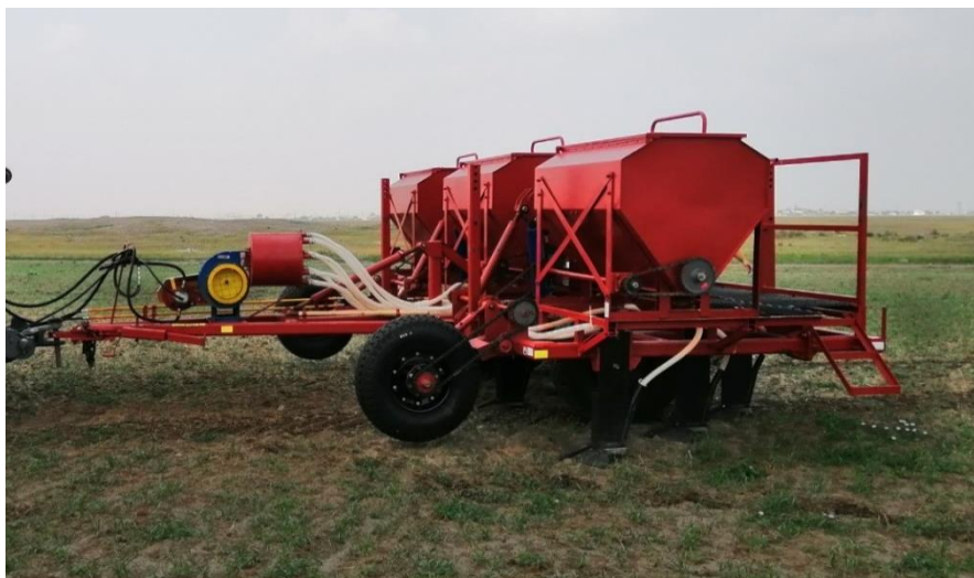
Рисунок 1 – Плоскорез-глубокорыхлитель для основной обработки уплотненных почв с подпочвенным внесением удобрений
