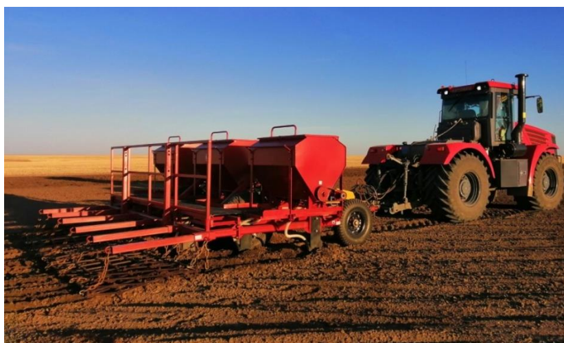
Рисунок 2 – Агрегат, состоящий из трактора К-735 и орудия для глубокой обработки и дифференцированного внесения минеральных удобрений в почву
