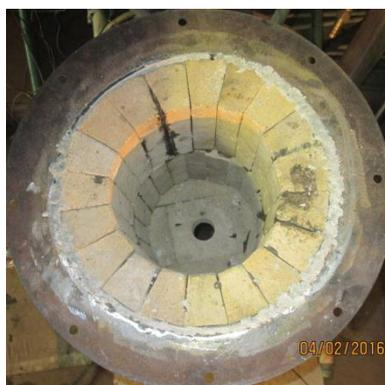
Рисунок 13 - Камера сжигания (вид сверху)
