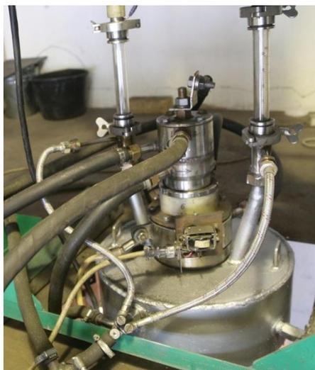
Рисунок 12 - Плазмоторн с системами подачи угля и воздуха
