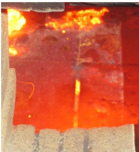
Рисунок 8 - Фотография донной части реактора с расплавом минеральной части древесных отходов после выключения плазмотрона.
