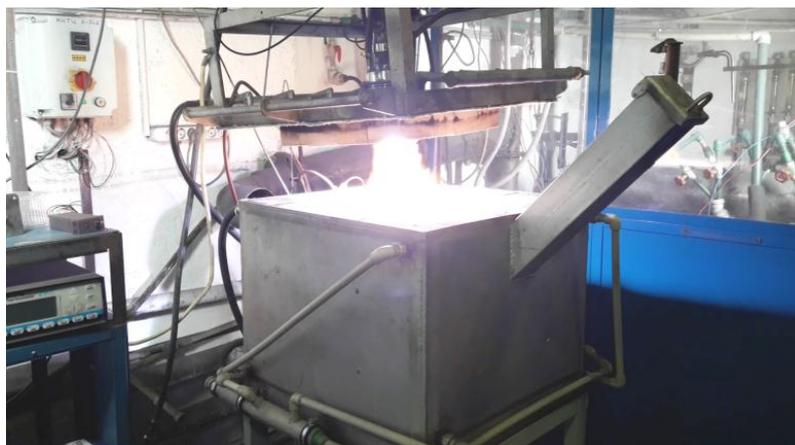
Рисунок 6 - Фотография работающего плазмотрона в плазмохимическом реакторе с поднятой крышкой.
