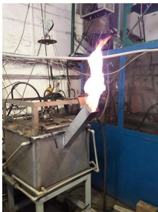
Рисунок 7 - Фотография факела горючего газа на выходе из патрубка для подачи брикетов древесных отходов.
