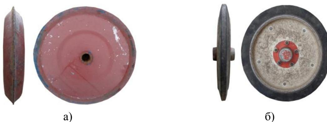
а –каток с клиновидным профилем; б –каток с трапециевидным профилем
