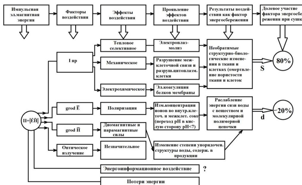
Рисунок 3 – Структурная схема проявления воздействия электроимпульсной энергии как фактора энергосбережения при сушке.
