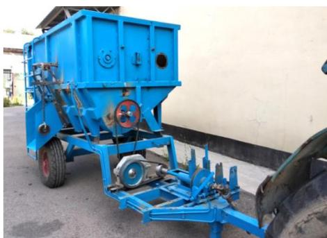
Рисунок 3 – Общий вид привода механизма горизонтального шнека
