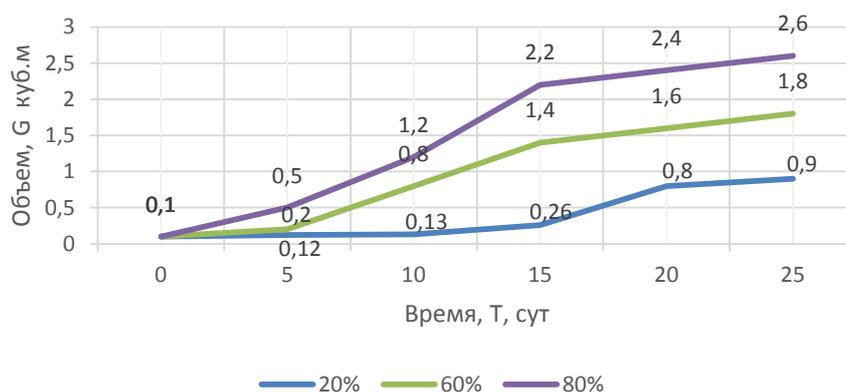
Рисунок 3 – Зависимость продолжительности стадий кислотного и щелочного сбраживания и выхода биогаза от дозы загрузки биомассы в биореакторах с объемом реактора 3 м<sup>3</sup> в мезофильном режиме – 20 % (200 л/сут); 40 % (400 л/сут); 60 % (600 л/сут) и 80 % (800 л/сут).
