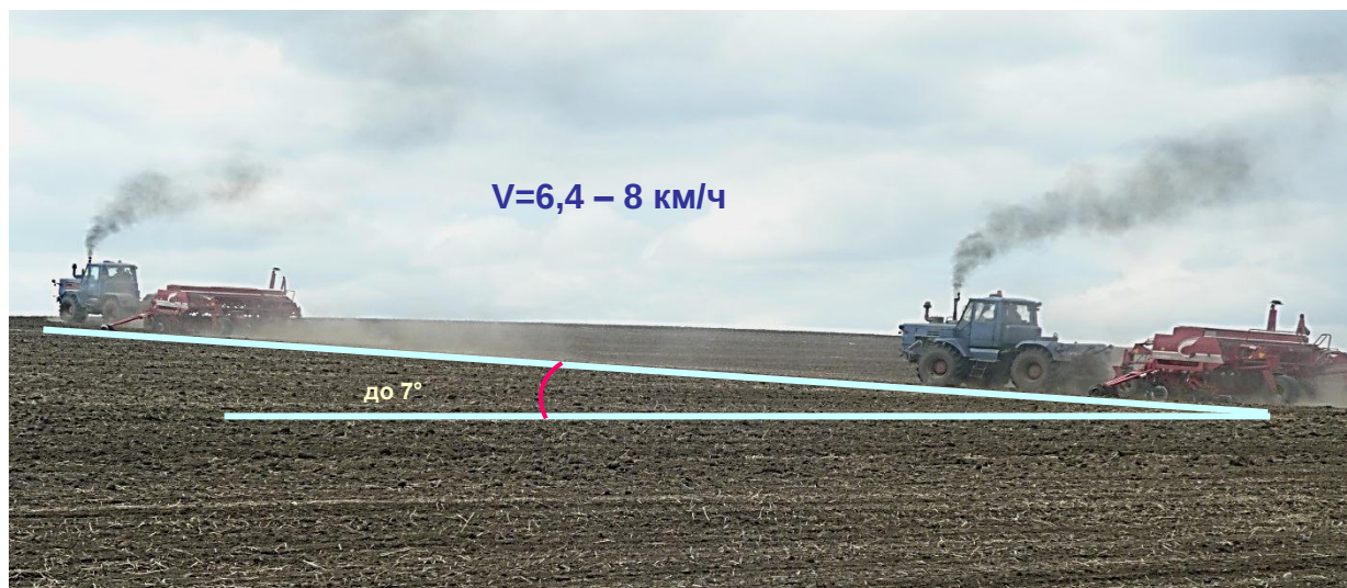
Рисунок 5 – Агрегатирование сеялки трактором Т 150 К.
