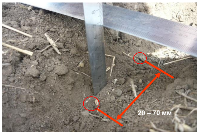
Рисунок 3 – Замеры глубины заделки семян и расстояния между семенами
