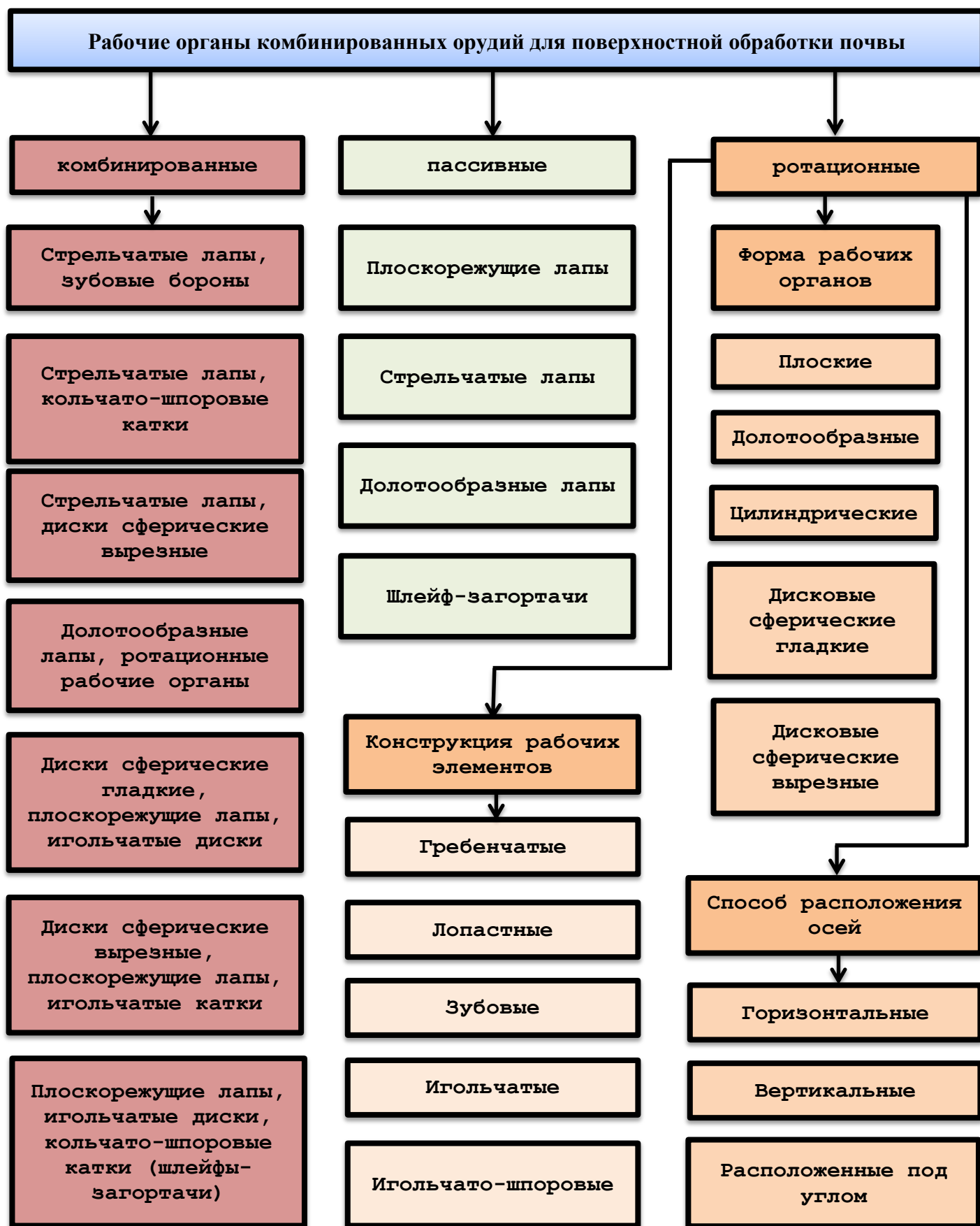
Рисунок 2 – Классификация рабочих органов комбинированных орудий для поверхностной обработки почвы
