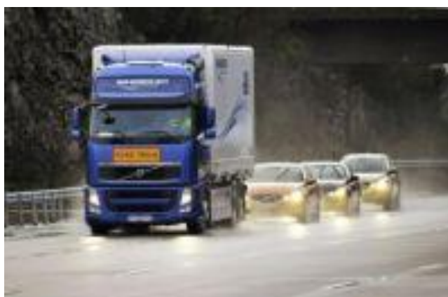
Сурет 6- Volvo-ның Safe Road Trains for the Environment (SARTRE) жүйесі.
