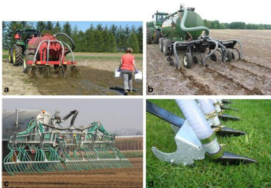
Рисунок 4 – Четыре способа внесения субстрата в почву: нанесение на поверхность с разбрызгиванием (а), подпочвенная внесения (б), с розливом из шлангов шланг (с) и прицепного сошника (d)
