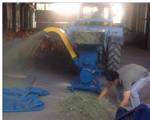
Рисунок 6 – Лабораторные испытания измельчителя грубых кормов
