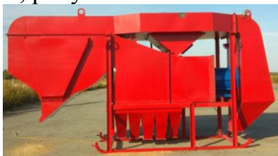
Рисунок 1 – Экспериментальный образец струйного пневмосепаратора с замкнутой системой воздушного потока
