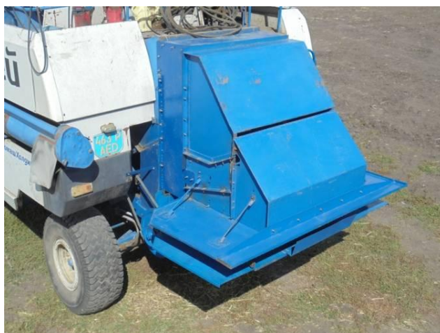
Рисунок 1 - Измельчитель-разбрасыватель соломы на комбайне Енисей КЗС-950
