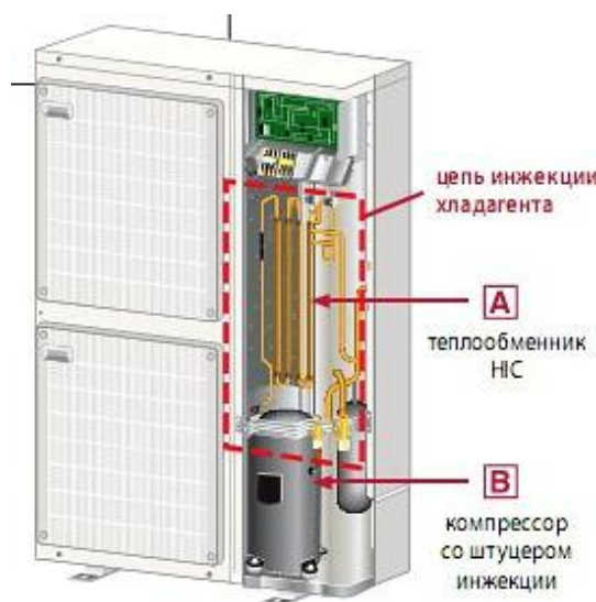
Рисунок 2 – Типичная схема компоновки ТН
