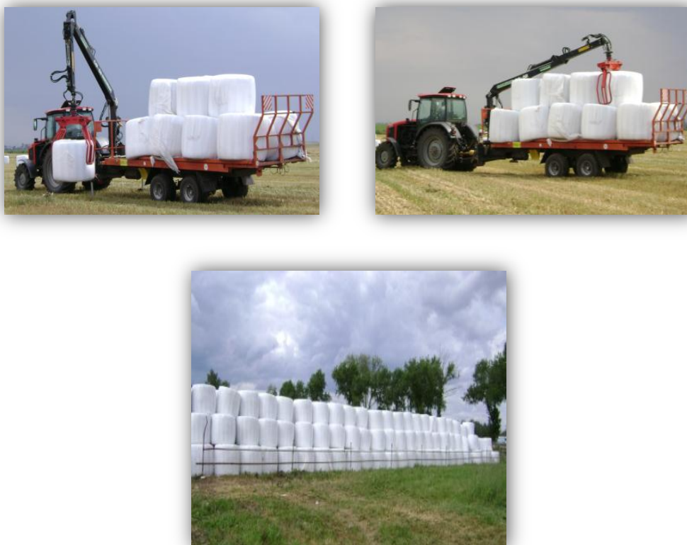
Рисунок 7 – Платформа с манипулятором ПМК-10 для подбора, перевозки и скирдования рулонов сенажа, упакованных в пленку
