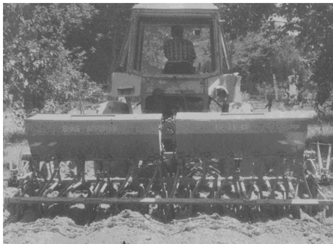
Рисунок 1 – Посев зерна сеялкой ДЕМ-3,6 по предварительно нарезанным бороздам
