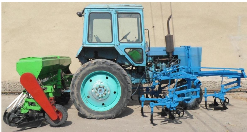
Рисунок 3 – Общий вид комбинированного агрегата с одновременной обработкой и сева зерновых культур в междурядья хлопчатника
