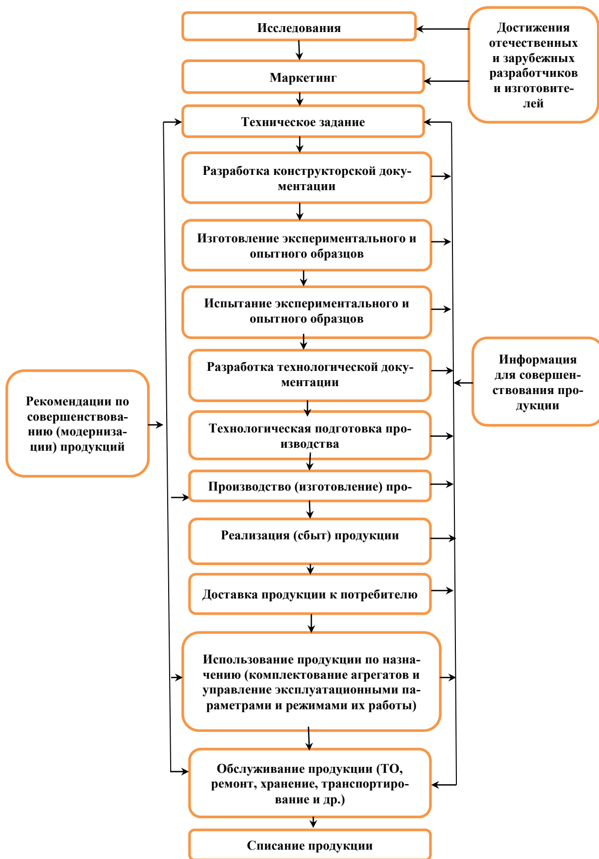
Рисунок 1 – Схема алгоритма разработки, производства, испытания, реализации, использования, обслуживания и списания продукции
