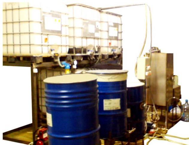
Рисунок 2 – Общий вид лабораторной установки производства биодизеля
