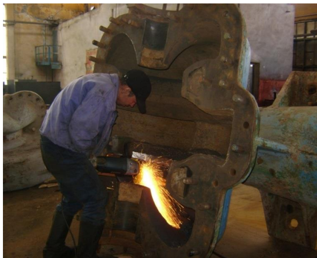
Рисунок 4 – Механическая обработка внутренней поверхности
