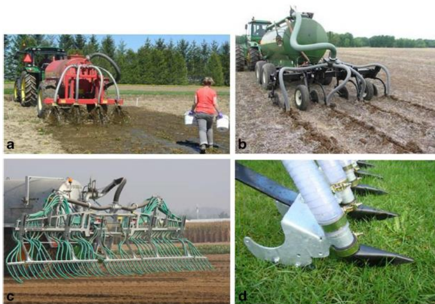
Рисунок 6 – Четыре способа внесения субстрата в почву: нанесение на поверхность с разбрызгиванием (а), подпочвенная внесения (б), с розливом из шлангов шланг (с) и прицепного сошника (d)
