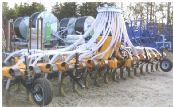
Рисунок 5 – Агрегат для внутреннего внесения жидких органических удобрений SN 800
