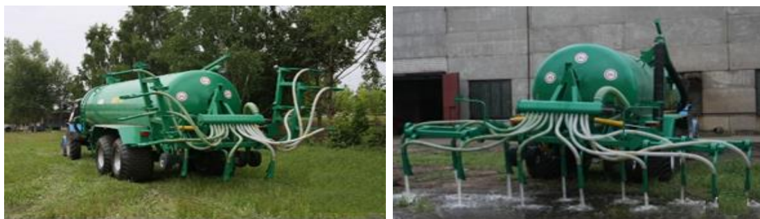
Рисунок 3 – Схема рабочего процесса адаптера АШУ-12 машиной для внесения жидких органических удобрений МЖУ-20
