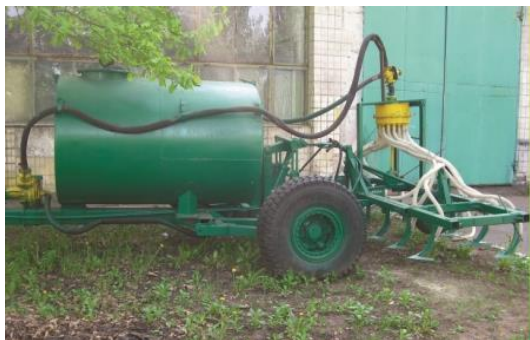
Рисунок 7 – Общий вид разрабатываемой машины подпочвенного внесения органических удобрений
