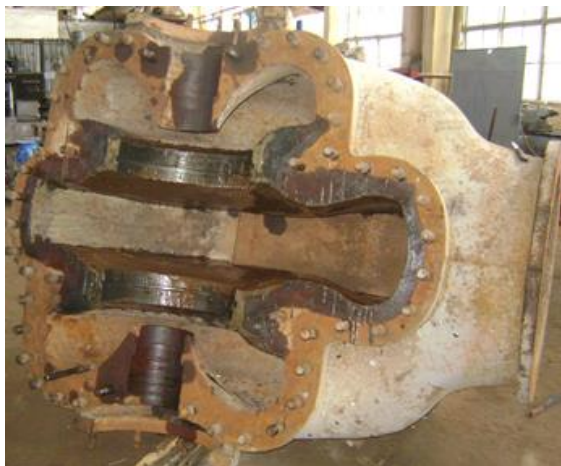
Рисунок 5 – Восстановленный корпус насоса
