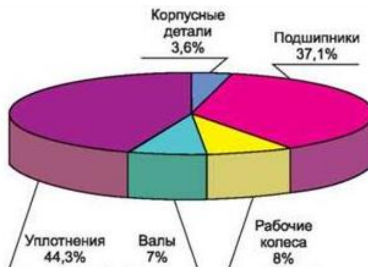
Рисунок 2 – Диаграмма распределения повреждений по элементам насосов
