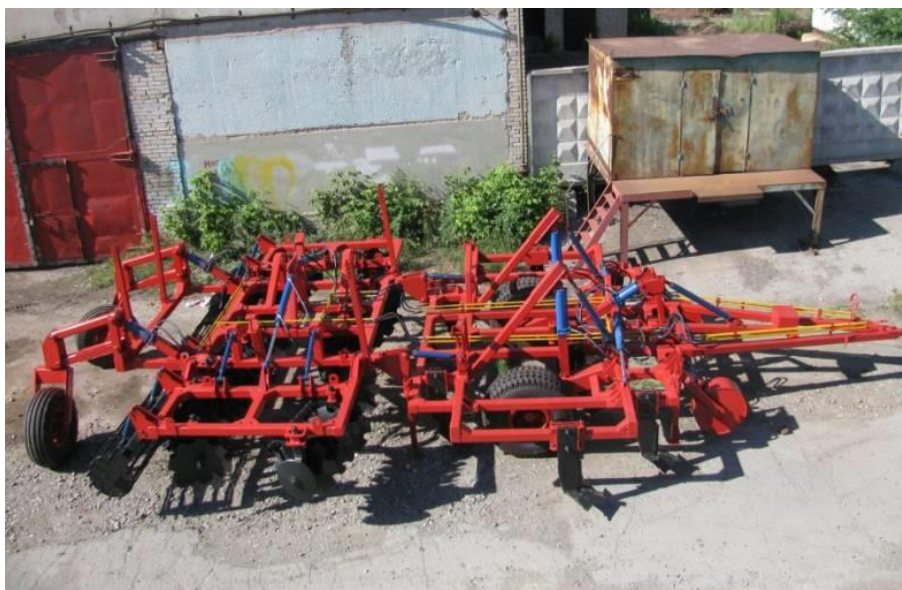
Рисунок 7 – Комбинированное орудие для основной обработки пласта трав. Общий вид
