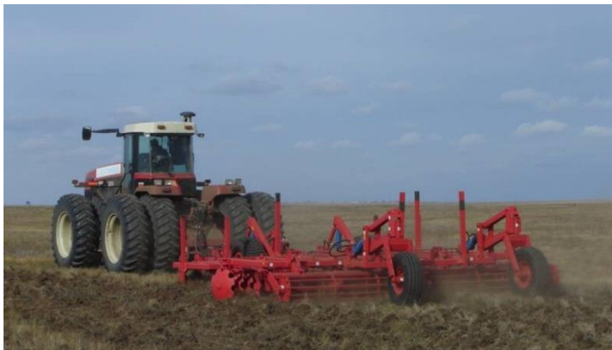
Рисунок 8 – Комбинированное орудие для основной обработки пласта трав в агрегате с трактором «Buhler-2375». Вид в работе
