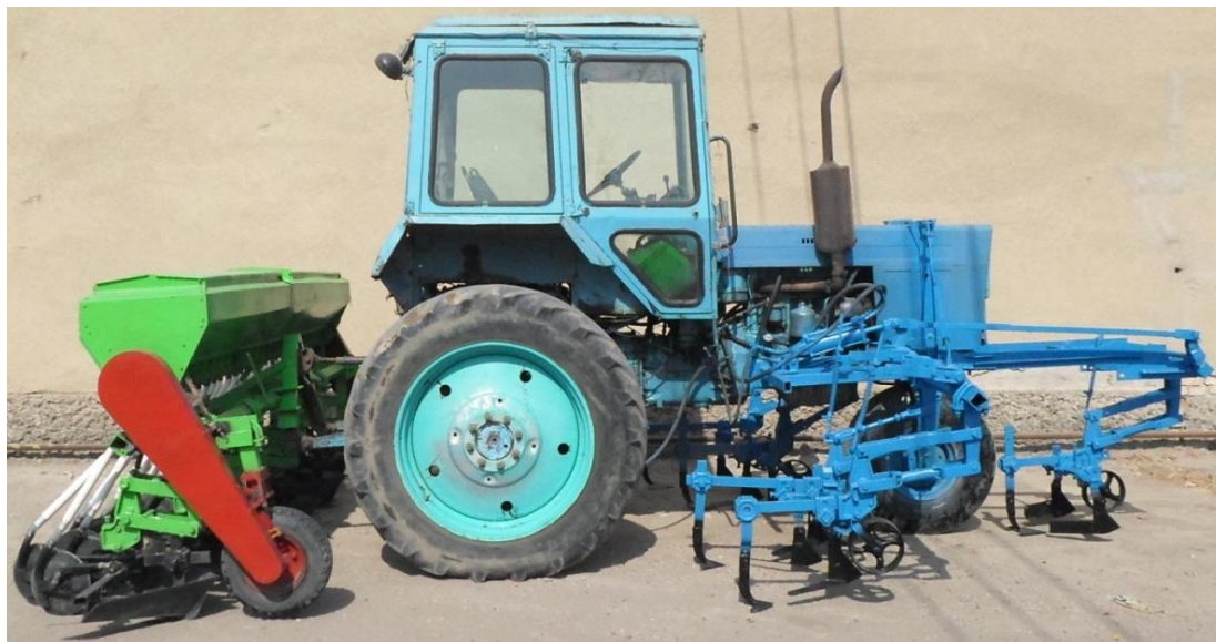
Рисунок 3 – Общий вид комбинированного агрегата с одновременной обработкой и сева зерновых культур в междурядия хлопчатника
