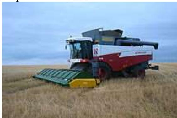
Рисунок 22 – Современная очесывающая жатка «Славянка УАС»
