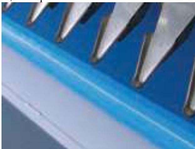
Рисунок 24 – Гребень колосо-уборочного комбайна Shelbourne
