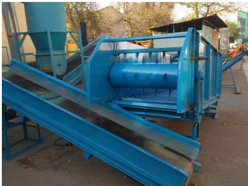
Рисунок 3 – Экспериментальный образец питателя-дозатора стебельных кормов
