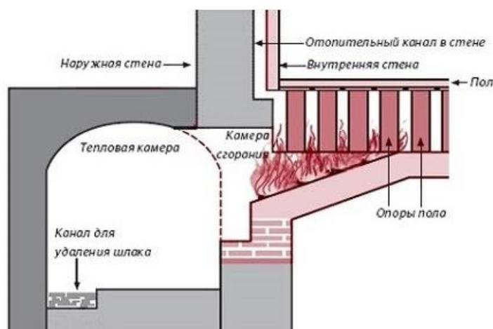
Рисунок 5 - Схема обустройства воздушного отопления проточного типа
