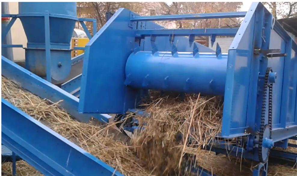
Рисунок 4 – Процесс подачи грубых кормов питателем-дозатором
