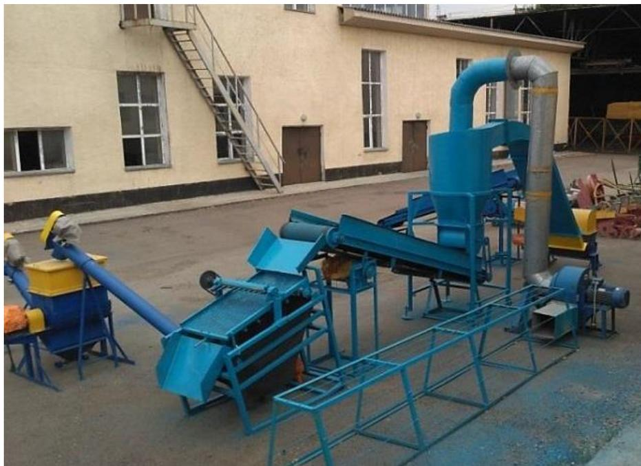
Рисунок 1 – Общий вид линии приготовления ВТМ из листовой части трав со стороны сепаратора и вентилятора
