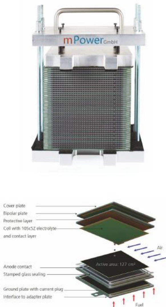
Рисунок 3 – Стек из планарных топливных элементов от mPower GmbH
