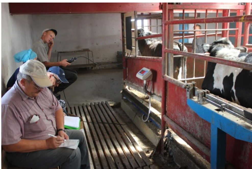
Рисунок 6 – Оборудование радиочастотной идентификации и взвешивания, вид в работе
