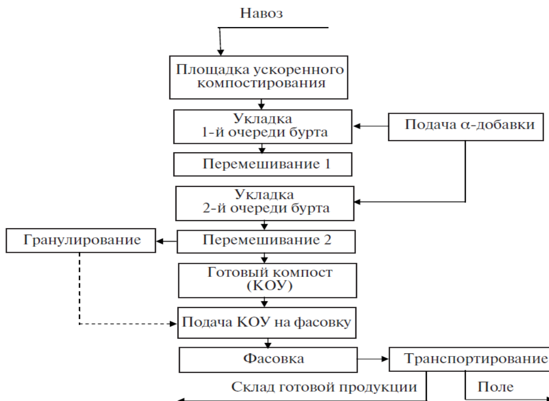
Рисунок 2 – Технологическая схема процесса производства КОУ методом ускоренного компостирования на основе твердого (подстилочного) навоза КРС
