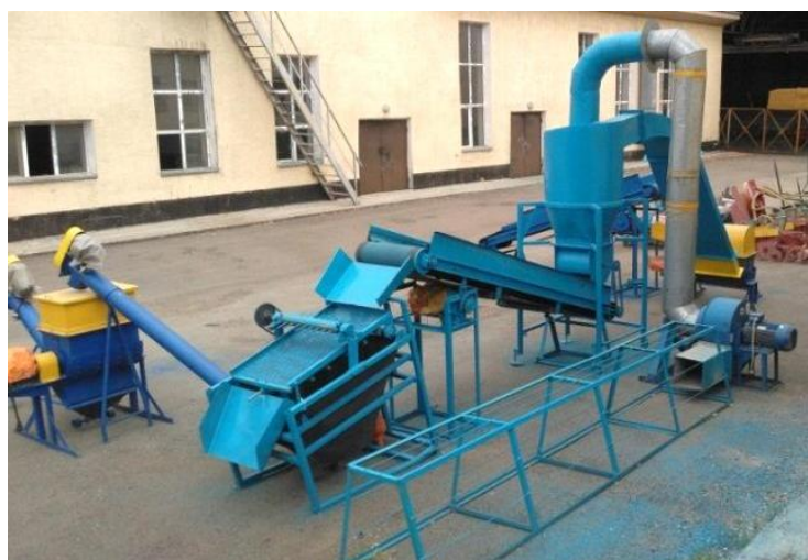
Рисунок 2 – Общий вид линии приготовления витаминно-травяной муки из листовой части трав со стороны сепаратора и вентилятора
