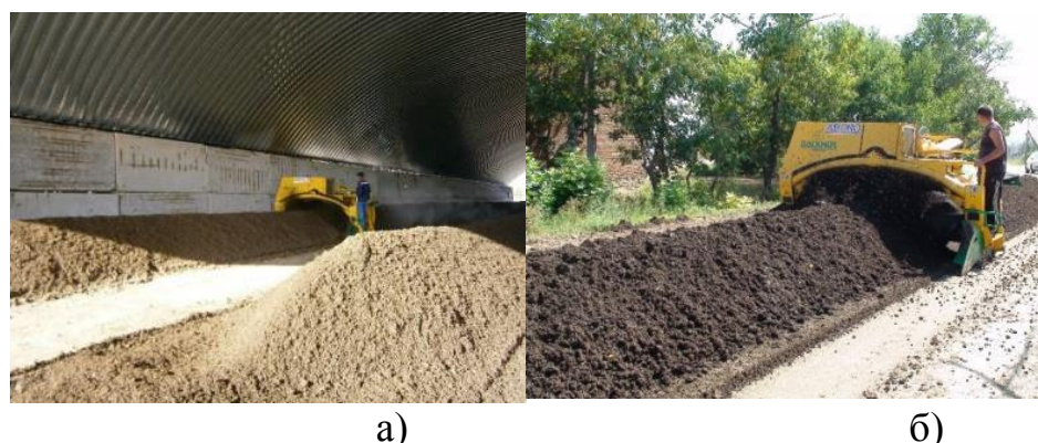
Рисунок 3 – Производство твердых КОУ: а) на площадке закрытого типа; б) на открытой площадке
