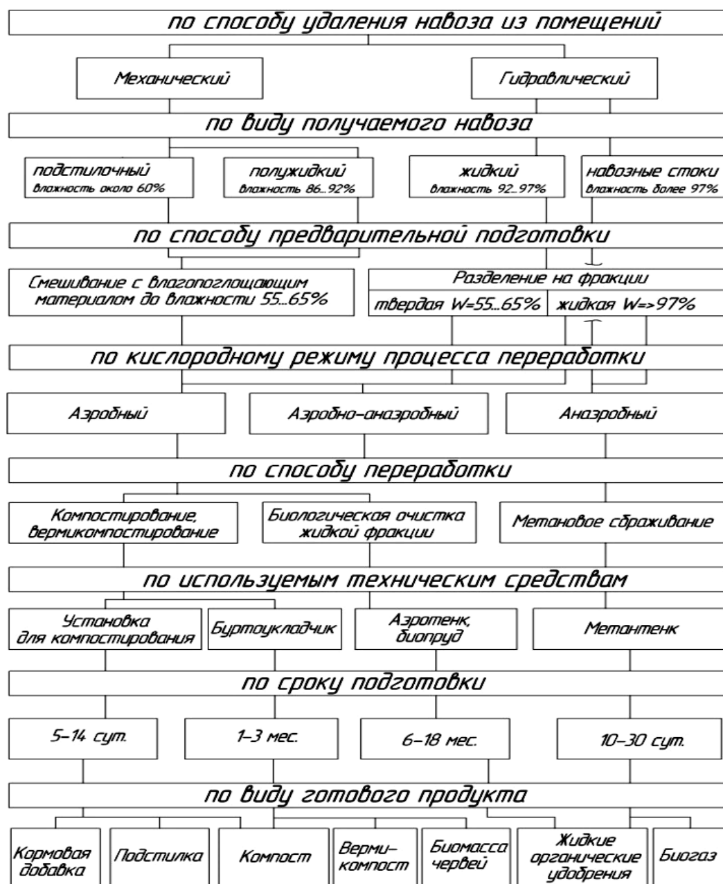
Рисунок 1 – Схема классификации технологий переработки навоза
