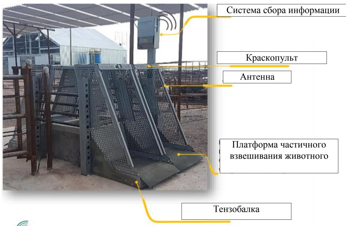
Рисунок 2 – Оборудование для взвешивания «GrowSafeSolutions», совмещенное с поилкой
