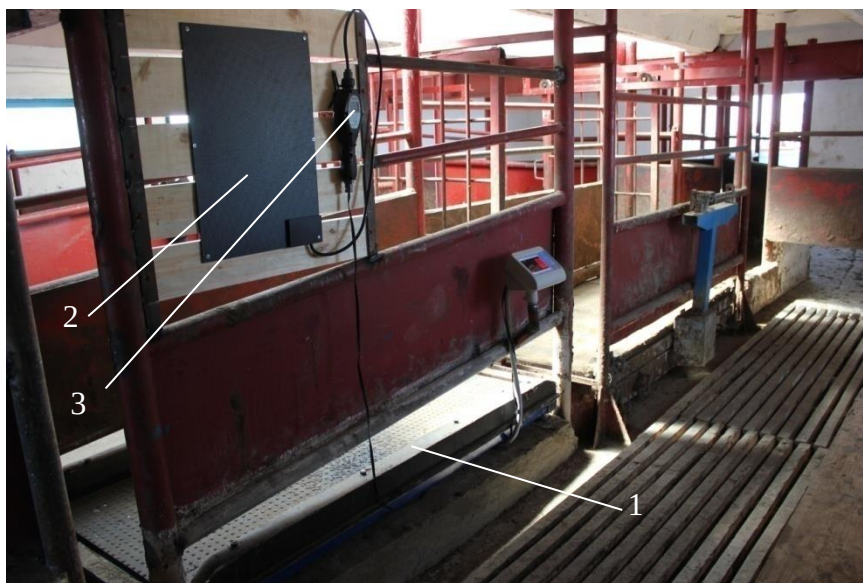
1 – электронные весы; 2 – стационарная антенна; 3 – считыватель Рисунок 5 – Схема расположения RFID оборудования при взвешивании животных
